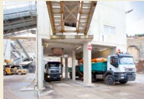
Parallelverladung: gleichzeitiges Verladen auf zwei Zielpunkte
