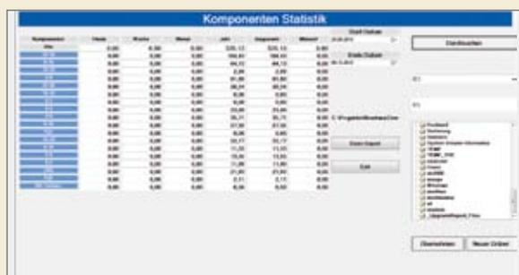
Bediener in jedem Standard WÖHWA PCS35 System die Materialstatistiken der verladenen Menge klar und übersichtlich dargestellt werden. Diese Statistiken werden über das Intranet (Ethernet) oder Internet (VPN) problemlos an übergeordnete Stellen weitergeleitet.
