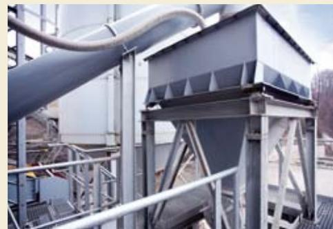
Behälterwaage mit Schnecke, gravimetrischer Zuschlag
